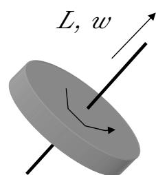
Il disco ruota intorno al suo asse con velocità angolare  $w$  dunque momento angolare  $L=wI$  ( $I$ : momento di inerzia del disco)
