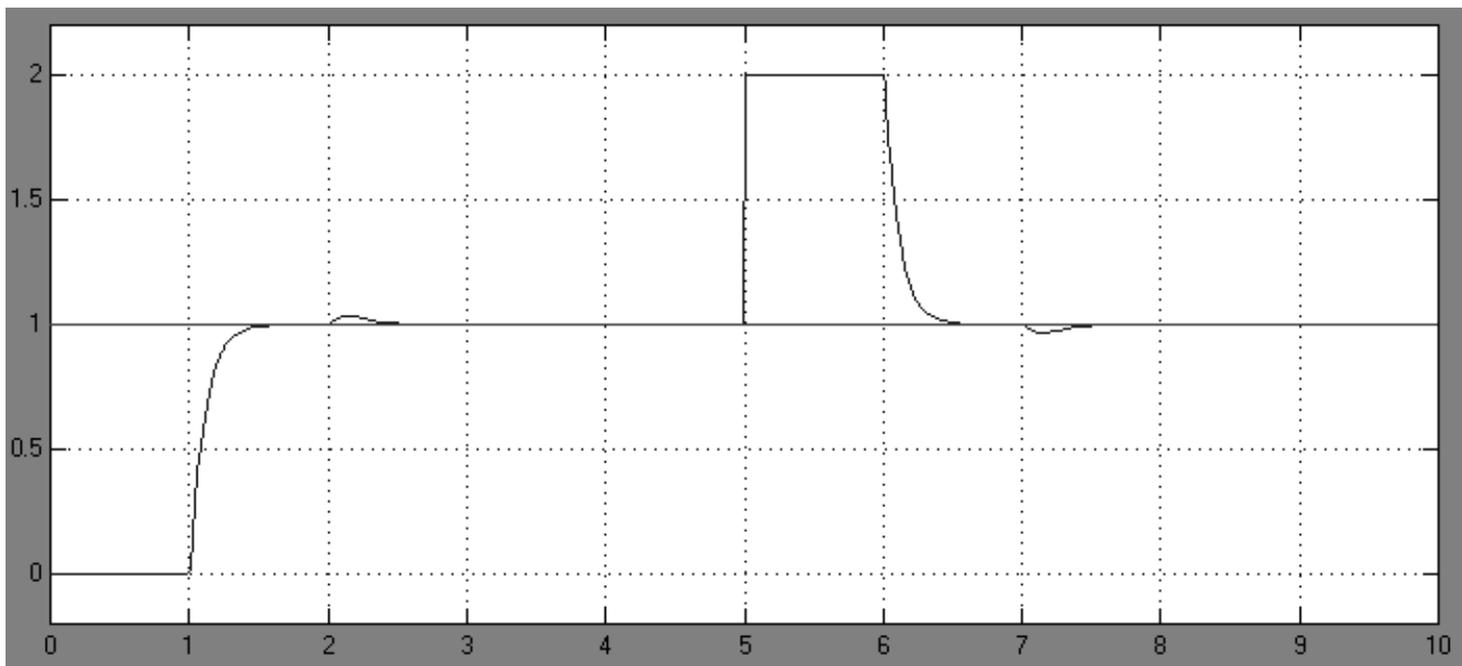
Simulazione per riferimento a gradino e disturbo  $d(t)$  a gradino che interviene dopo 5 secondi
