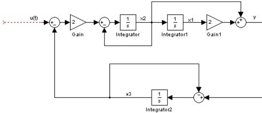
2. Si progetti un regolatore a tempo discreto con tempo di campionamento  $T_s = 1$  s assumendo di misurare tutto il vettore di stato, determinando il guadagno  $K$  del regolatore mediante posizionamento degli autovalori ad anello chiuso in  $[0.4 \ -0.4 \ 0.6]'$ . Si simuli per 50 s il comportamento ad anello chiuso per condizione iniziale  $x_1(0) = 1, x_2(0) = 0, x_3(0) = 1$ .
