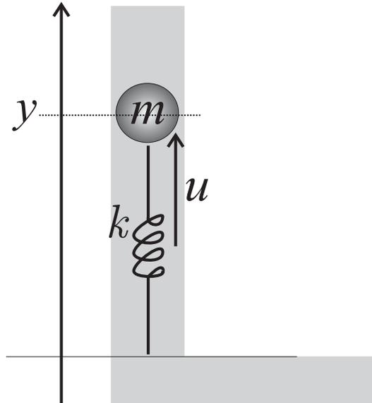
Si consideri il sistema rappresentato in figura, costituito da una pallina da ping pong di massa  $m$  che si muove all'interno di un condotto verticale, collegata con un elastico di costante  $k$  al livello di riferimento. Mediante una pompa si è in grado di immettere aria nel condotto, esercitando una forza  $u$  sulla pallina. Questa si muove all'interno del condotto con attrito viscoso di coefficiente  $\beta$ .
