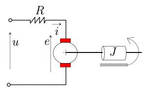
dove J è il momento di inerzia complessivo (carico + rotore del motore), R la resistenza del circuito di eccitazione, k è la costante del motore,  $\beta$  il coefficiente di attrito viscoso, u la tensione di eccitazione, e la forza controelettromotrice, T la coppia prodotta dal motore e  $\theta$  la posizione del carico.
